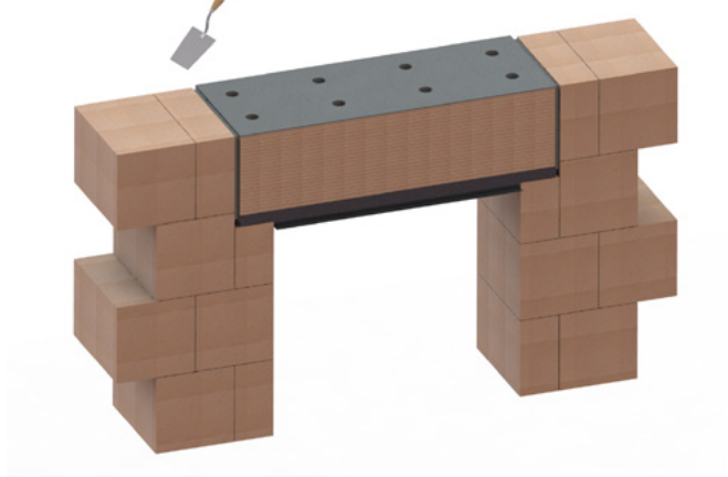
Fuge zwischen Kastenstirnseite und Mauerwerk satt vermörteln
