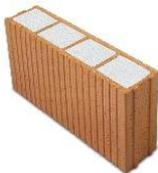
**Bildtext:** Porotherm 12-50 WDF Perlit Plan: Diffusionsoffenes Innendämmsystem, das freistehend vor die trockene Bestandswand gemauert wird; die stabile Ziegel-Hülle ist mit Perlit gefüllt und gut geeignet, wenn die Außenwandsanierung schwer möglich ist.
